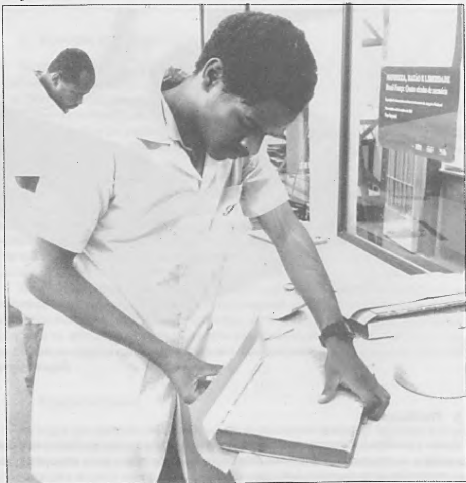
Reparo do lombo com tecido reforçado
