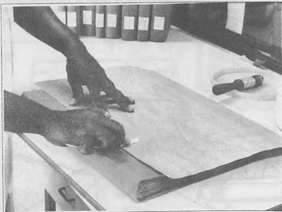
Revestimento da capa com papel Kraft
